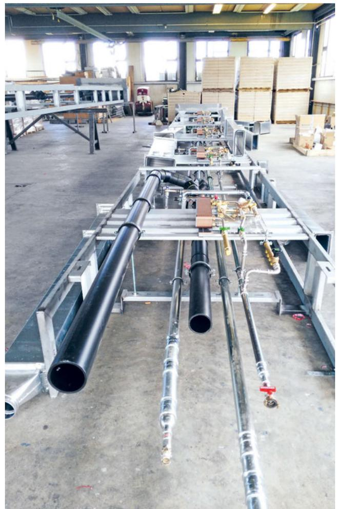
B&B Hotel Zürich Airport: Das sechsgeschossige Gebäude umfasst 170 Zimmer und wurde von A-Z mit Hilfe von Building Information Modeling (BIM) geplant und gebaut. Dies gilt auch für die insgesamt 18 Steigzonen für die Gebäudetechnik. In den vorgefertigten, 18 m langen Modulen sind unter anderem Vorlauf und Rücklauf für Kühlung, Wärme und Frischwasserstationen untergebracht, ebenso Leitungen für Schmutzwasser, Zu- und Abluft sowie die Elektroleitungen.
